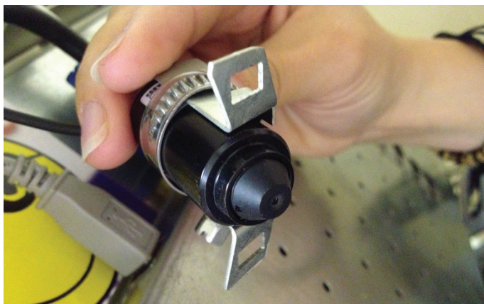
Камера. Габаритами сравнима с батарейками типоразмера С
